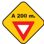
PROXIMIDAD DE SEÑAL RESTRICATIVA (paso)
