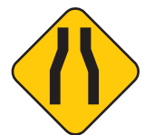
ESTRECHAMIENTO (en las dos manos)
