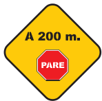
PROXIMIDAD DE SEÑAL RESTRICATIVA (pare)
